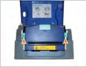
Press locking levers inward
